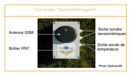
La centrale d'acquisition TensioManager® enregistre et transmet automatiquement les données des sondes tensiométriques selon la fréquence de mesure souhaitée.
